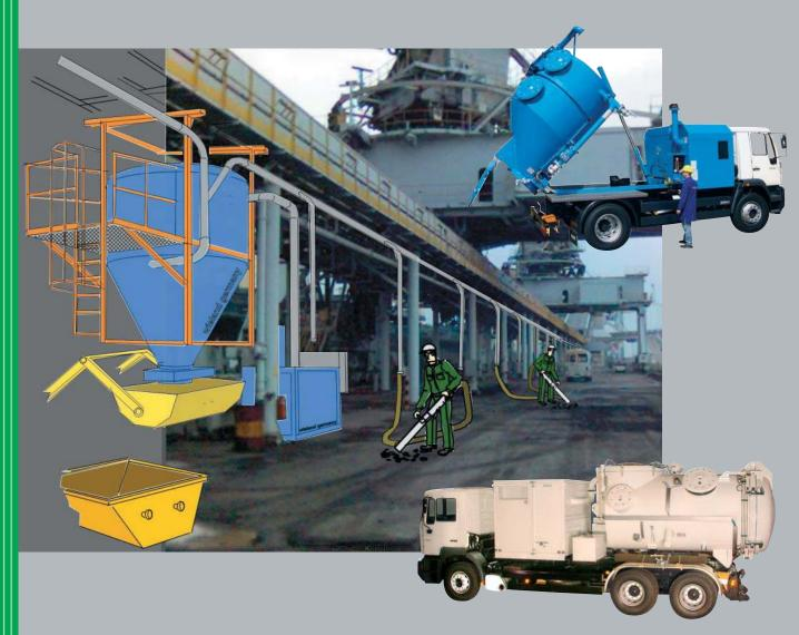
Мощные промышленные пылесосы с дизельным и пневматическим приводом, стационарные системы вакуумной очистки с централизованным сбором и выгрузкой материала:
