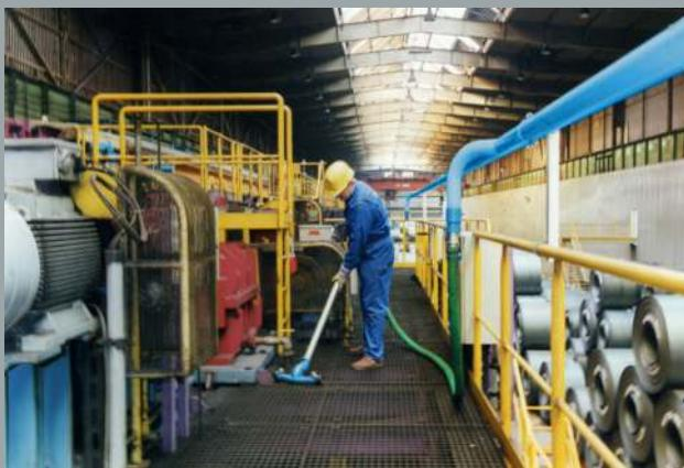
В процессе плавки и разливки стали пыль витает в воздухе и рассеяна на всем протяжении плавильного цеха. Осевшая пыль приводит к увеличению нагрузки на несущие конструкции цеха, вызывает износ и проблемы в работе технологического оборудования, представляет проблему безопасности и здоровья рабочих.
