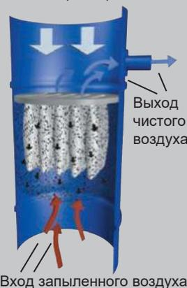
Система AirShock® работает в автоматическом режиме и, через определенные промежутки времени, регенерирует рабочий фильтр, сбивая с него грязь обратным потоком воздуха (обратная продувка). Всасывающий тракт на время регенерации закрывается.
